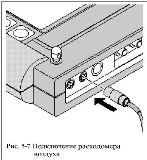
Рис. 5-7 Подключение расходомера воздуха
