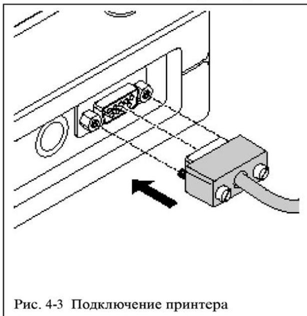
Рис. 4-3 Подключение принтера
